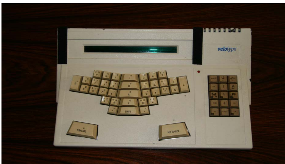
Figura 4: Velotyping : Il sistema fonetico su cui si basa permette di digitare la forma grafemica di singoli fonemi anziché l'ortografia. © SysMedia LTD.
